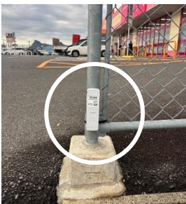
敷地内の最も低い場所にセンサを設置。 DAISO メリーランド武雄店では 駐車場入口のフェンスに設置。
